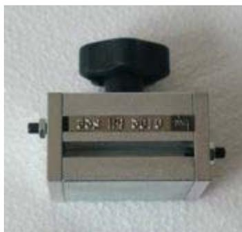
В стандартную комплектацию маркировочного станка входит двухлинейная маркировочная головка с 32 символами, также возможна поставка отдельных дополнительных наборов символов.
