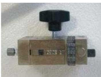
В качестве опции поставляется однорядная маркировочная головка с десятизначной маркировочной линейкой и трехзначным поворотным
